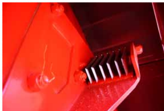
7 couteaux mobiles par pale = 56 au total
