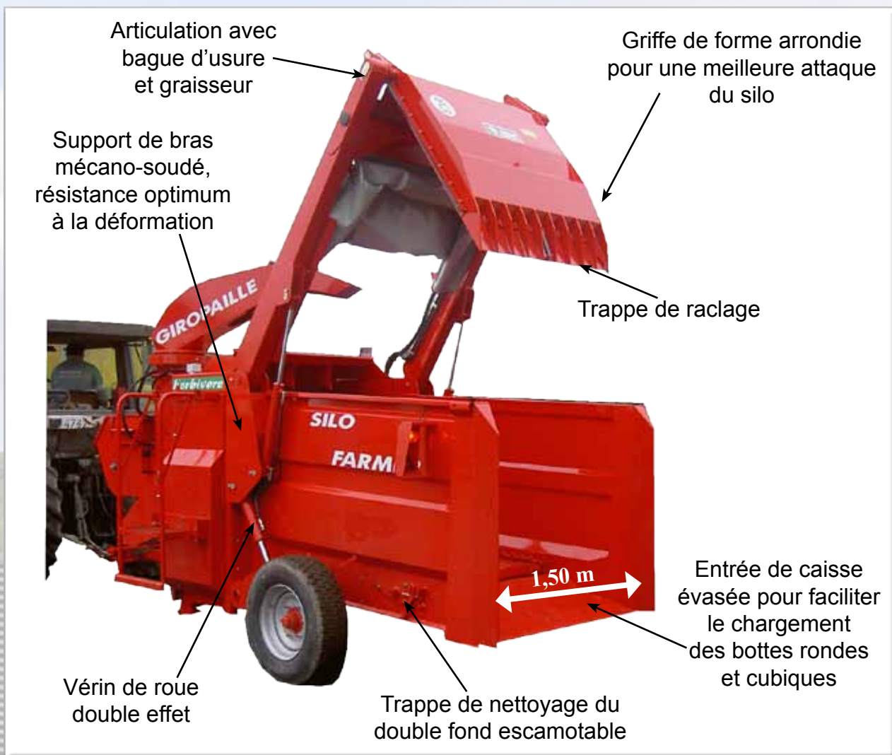
démêleur par hydraulique (DP560GL et GTL)
