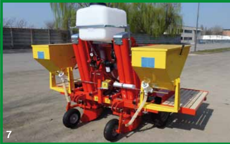
1 - Assolcatore fisso regolabile in altezza - Soc fixe avec hauteur réglable Fixed furrow with adjustable height - Festen Furchenziehern mit verstellbarer Höhe 2 - Dischi ricopritori con molla telescopica di pressione - Disques de recouvrement avec un ressort télescopique pour la pression - Covering discs with telescopic depth's spring - Scheibensechen verstellbaren durch eine Druckfeder 3 - Elevatore a tazze con cinghie in gomma a doppio rango - Elevateur à godets avec bandes en caoutchouc (double rangées) - Rubber elevator belts with two lines of interposed scoop cups - Zwei Reihen Schöpfbecher am Gummigurt 4 - Tramoggia fissa per seme sufficiente a percorrere circa 800 mt. - Trémie fixe pour parcourir environ 800 mt. - Fixed hopper for seed enough to operate approximately 800 mt. - Fester Saatbunker genug für 800 mt. ca.
