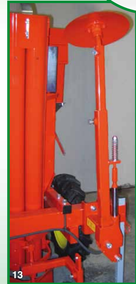
12 - Griglia sul fondo della tramoggia (Opt.) - Grille sur le fond de la trémie (Opt.) Grate on the hopper's bottom (Opt.) - Sieb über den Boden des Bunkers (Opt.) 13 - Tracciafila idraulico (Opt.) - Traceur hydraulique (Opt.) Hydraulic row maker (Opt.) - Hydraulische Spuranreifer (Opt.)
