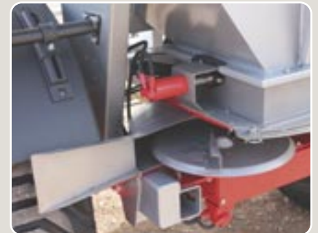
9 Discos, agitador y fondo de tolva de acero inoxidable. Grupo distribuidor TDC-540 Stainless steel discs, agitator and backdrop hopper. Gear distributing TDC-540
