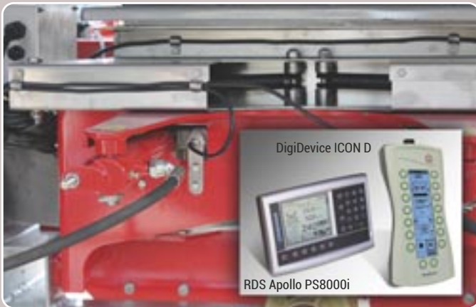
19 Control electrónico de la dosificación Electronic spreading rate control
