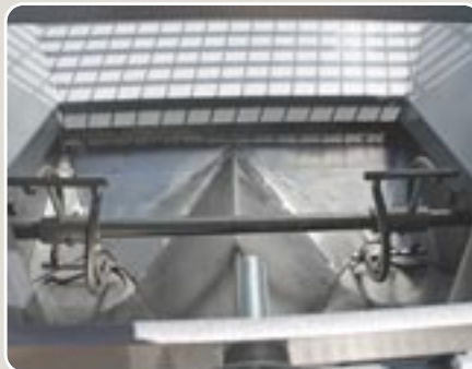
8 Agitador de bajas revoluciones con sistema hidráulico independiente Low speed revolutions agitator with independent hydraulic system
