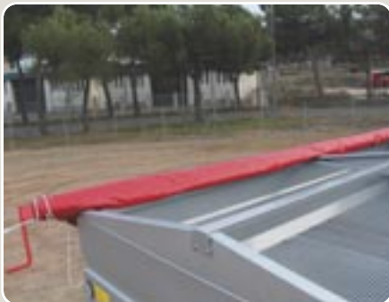
7 Toldo abatible, tipo camión, con arillos de chapa plegada Lorry type folding tarpaulin with folded sheet
