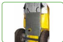
Quilha de proteção inferior do reservatório em chapa galvanizada
