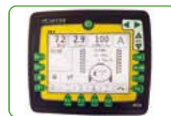
Computador CB9 para controle automático de distribuição
