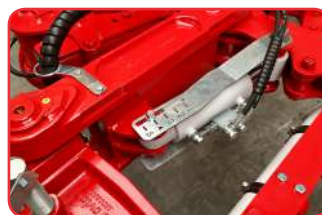
Sistema de paralelogramo entre cabeça e chassis que permite o ajuste hidráulico do 1º corpo incluso em marcha (opcional)
