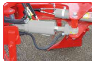
Sistema de Memória automática (de série para 5 corpos)
