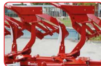
Novo desenho dos cepos para melhorar o fluxo de resíduos
