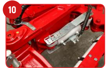
Ajuste hidráulico 1º corpo
