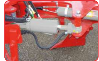
Sistema de memória automática (de série para 5 corpos e XP)
