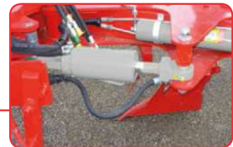
Sistema de memória automática (standard para 5 corpos)
