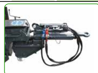
Lança com transmissão giratória de engrenagens e bloqueio hidráulico (1000-3000 L).
