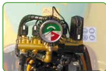
Eletroválvula em latão, abertura dir./esq., regulação manual de pressão, filtro autolimpante, manómetro isométrico Ø 100 mm.
