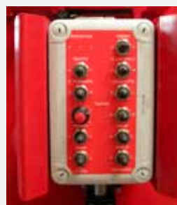
Boîtier électrique toutes fonctions et 4 fonctions sur la passerelle.
