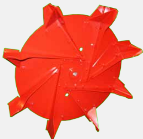
Turbine de ventilation à 8 pales renforcées recouvrant le disque en son centre pour une bonne rigidité de l'ensemble.
